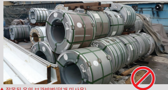
▲ 잘못된 옥외 보관방법(덮개 미사용)
