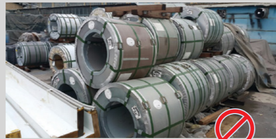
▲ 잘못된 옥외 보관방법(덮개 미사용)
